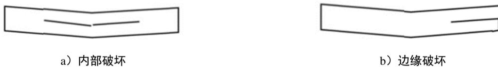
图E.3 试样层间剪切破坏模式示意图
