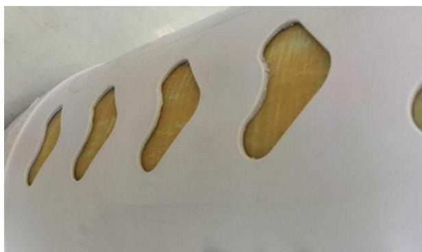
图 A. 7 化学腐蚀变色
