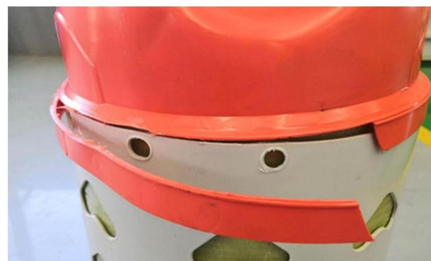
图 A. 4 套部件损坏，无法有效安装
